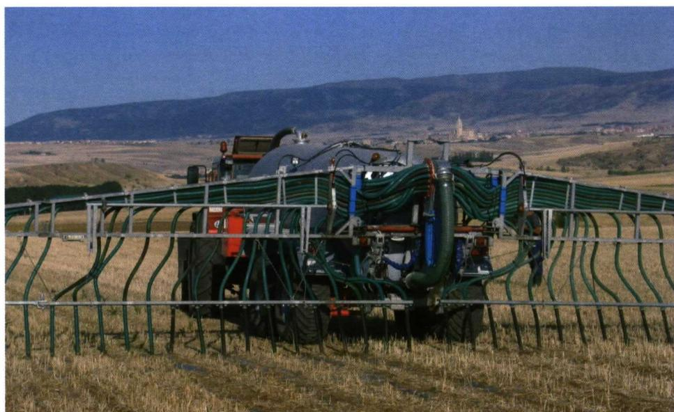
**Figura 3.** Sistema de bandas para la aplicación de purín al campo.
