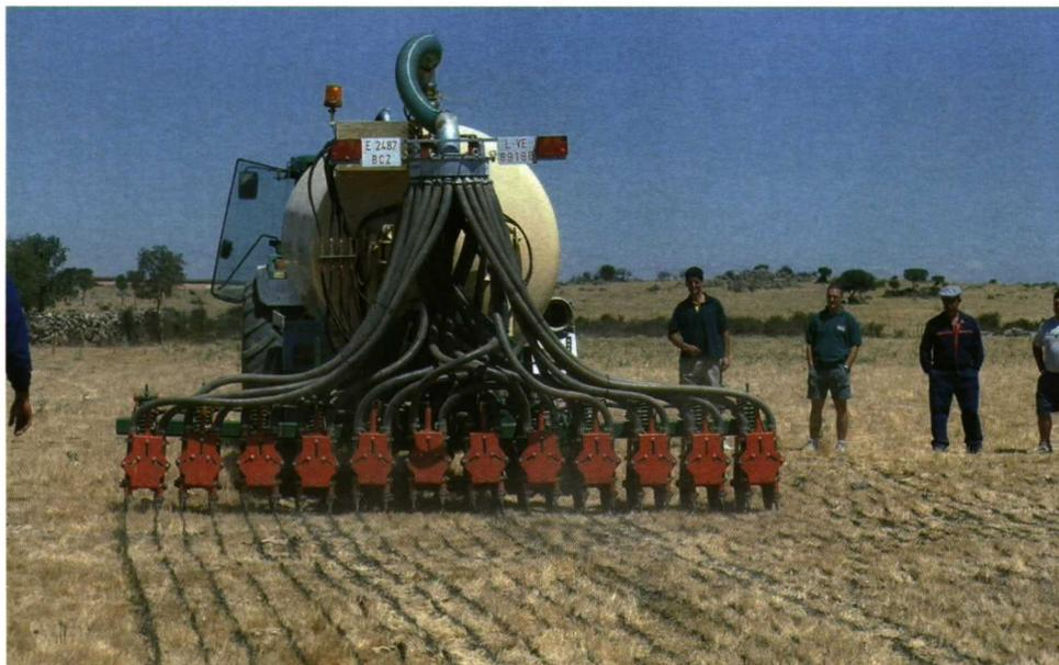
**Figura 4.** Sistema de discos para la aplicación de purín al campo.
