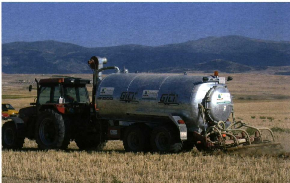
**Figura 5.** Sistema de inyección para la aplicación de purín al campo.
