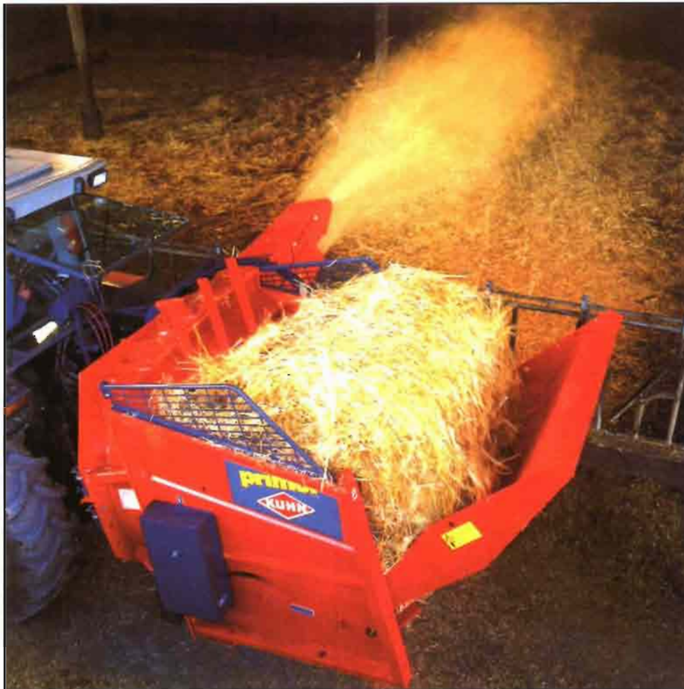
Fig. 4.-Picadora de eje horizontal, con rotores fresadores, y turbina de expulsión del picado.
