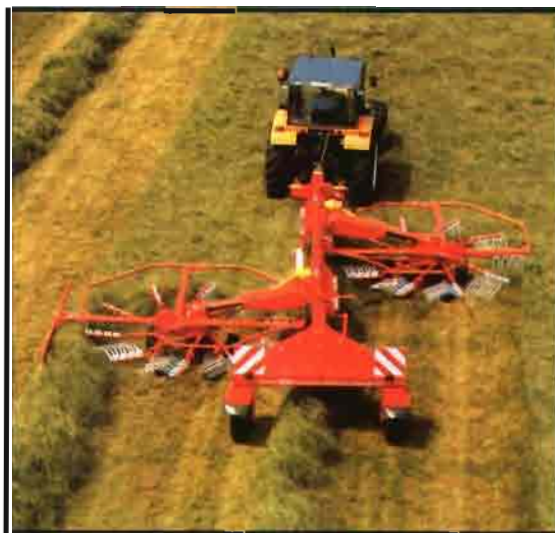
Hilerador rotativo GA 7302 DL de Kuhn, formando dos hileras.
