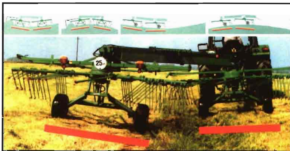
Sistema de adaptación al terreno mediante timón articulado, de Stoll.
