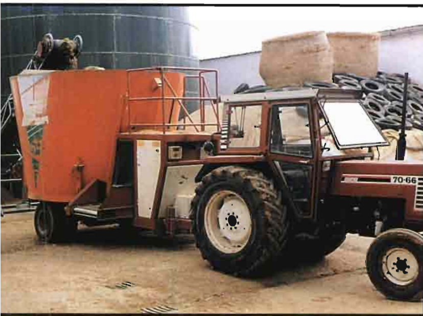
La capacidad del carro mezclador se calcula en relación a 1m 3 /7-12 vacas día.
