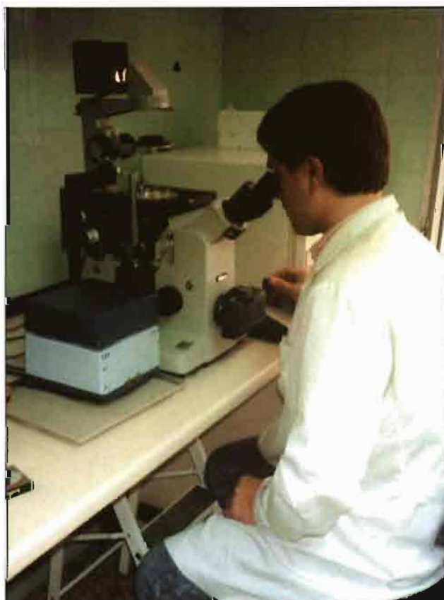
Biopsia embrionaria mediante micromanipulador automático conectado al microscopio invertido.
