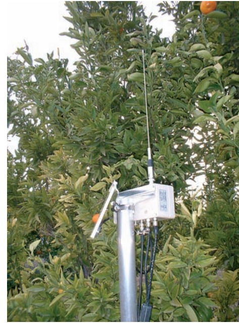
Este sistema ofrece al agricultor datos precisos sobre la dosis de agua que debe aplicar en cada momento. Antena de transmisión al centro de datos.
