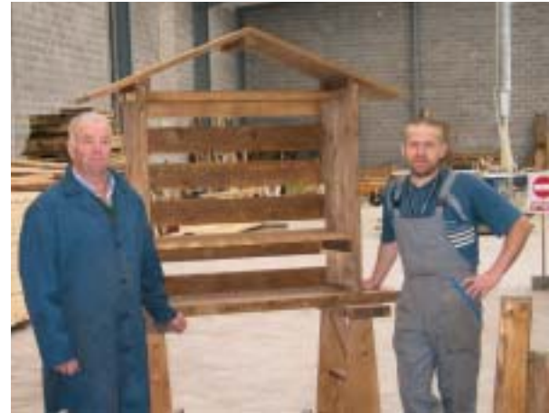
En la empresa Maderas Americano Villatresmil cortan y arman provisionalmente las paneras y hórreos para luego montarlos en su emplazamiento definitivo.
