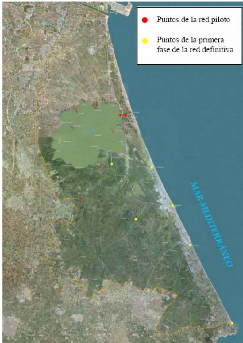
Figura 22 Situación de los equipos de medida de la red de control hidromorfológico
