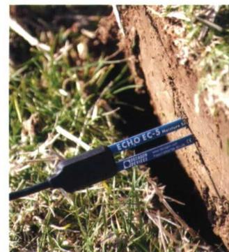
Izda. Vista del campo de ensayo. Centro. Nodo repetidor y nodo sensor de la red inalámbrica ZigBee. Dcha. Sensor capacitivo EC-5 para medir la humedad del suelo
