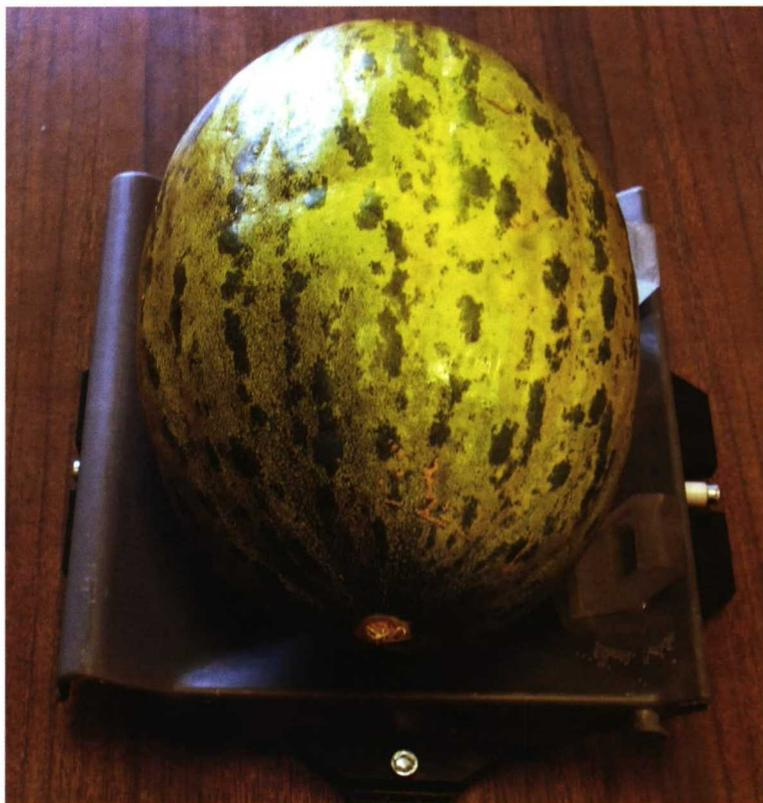
desea evaluar; por ejemplo si se desea un sistema de transmitancia la cazoleta debe permitir el paso de la radiación a su través (fotografía 4).
