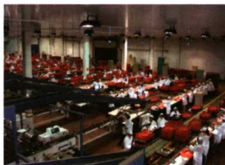
El almacén de confección de Cuna de Platero tiene una superficie de 12.500 m 2 . En ellas hay instaladas 17 líneas que tienen una capacidad de producción de 3.5 camiones por hora con un estricto seguimiento de la cadena de frío.
