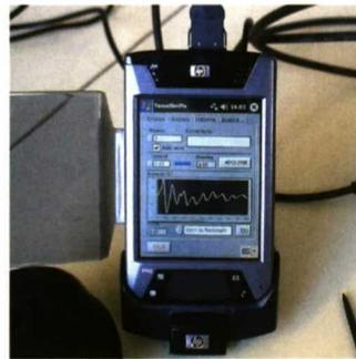
**Dispositivo portátil introducido en cooperativa para 'site acceptance test' (izquierda); detalle de la PDA y señal adquirida en una medida acústica sobre una unidad de buena calidad interna (derecha).**
