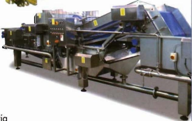
Línea monobloque de pelado y corte de patatas y zanahoria
