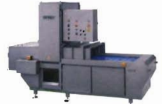
MULTICORER Para descorazonar y dividir en un solo paso, productos como pimientos, lechugas, repollo, etc.
