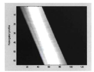
$s_r(x)$  es el perfil de referencia y w es el número de punto dentro del perfil. El valor que minimiza las funciones distancia ( $d_c$  o  $d_{mc}$ ) se obtiene para el conjunto de perfiles analizados. Con estos valores se calcula el desplazamiento medio entre perfiles consecutivos ( $\Delta x$ ).
