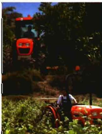
Los tractores Catron IC85, en sus dos versiones, frutero y viñero, nacen como el primer proyecto de una nueva marca de tractores en el mundo, dentro del segmento de los tractores de 85 CV, disponiendo de un potente motor Deutz y con una gama de 24 + 24 velocidades que permiten trabajar con mayor rapidez, seguridad y comodidad pudiendo alcanzar la velocidad de 40 km/hora.
