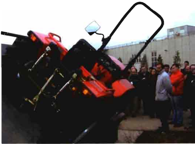
Demostración de la estabilidad y resistencia al vuelco
