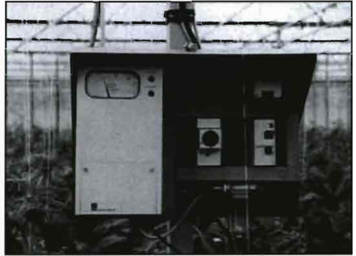
Analizador fijo de CO 2 bajo invernadero
