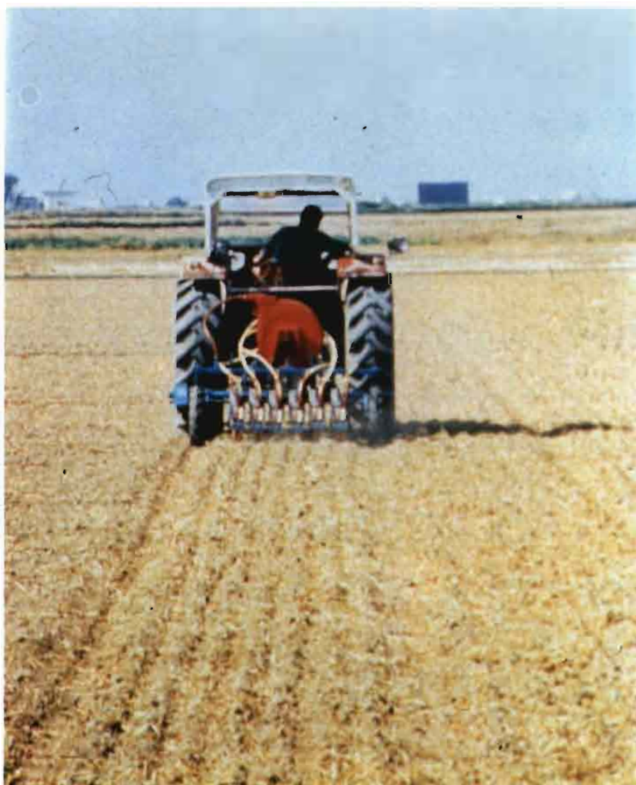
Siembr de cebolla con sembradora neumática.
