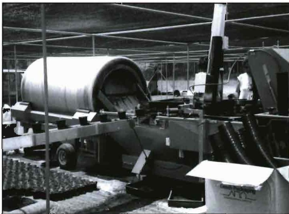
La maquinaria de Cermosan S.L., permite que el sustrato se prepare automáticamente y vaya llenando la plantadora. Las macetas van entrando una a una al ritmo marcado y tras ser plantadas salen por la cinta transportadora hasta la tabla.
