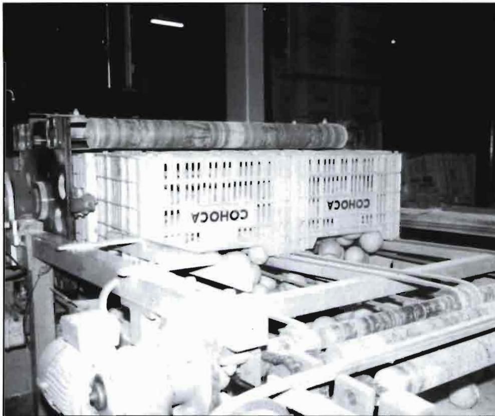
La imagen muestra una despaletizadora-volteadora-apiladora de envases vacíos. Debajo, una flejadora.
