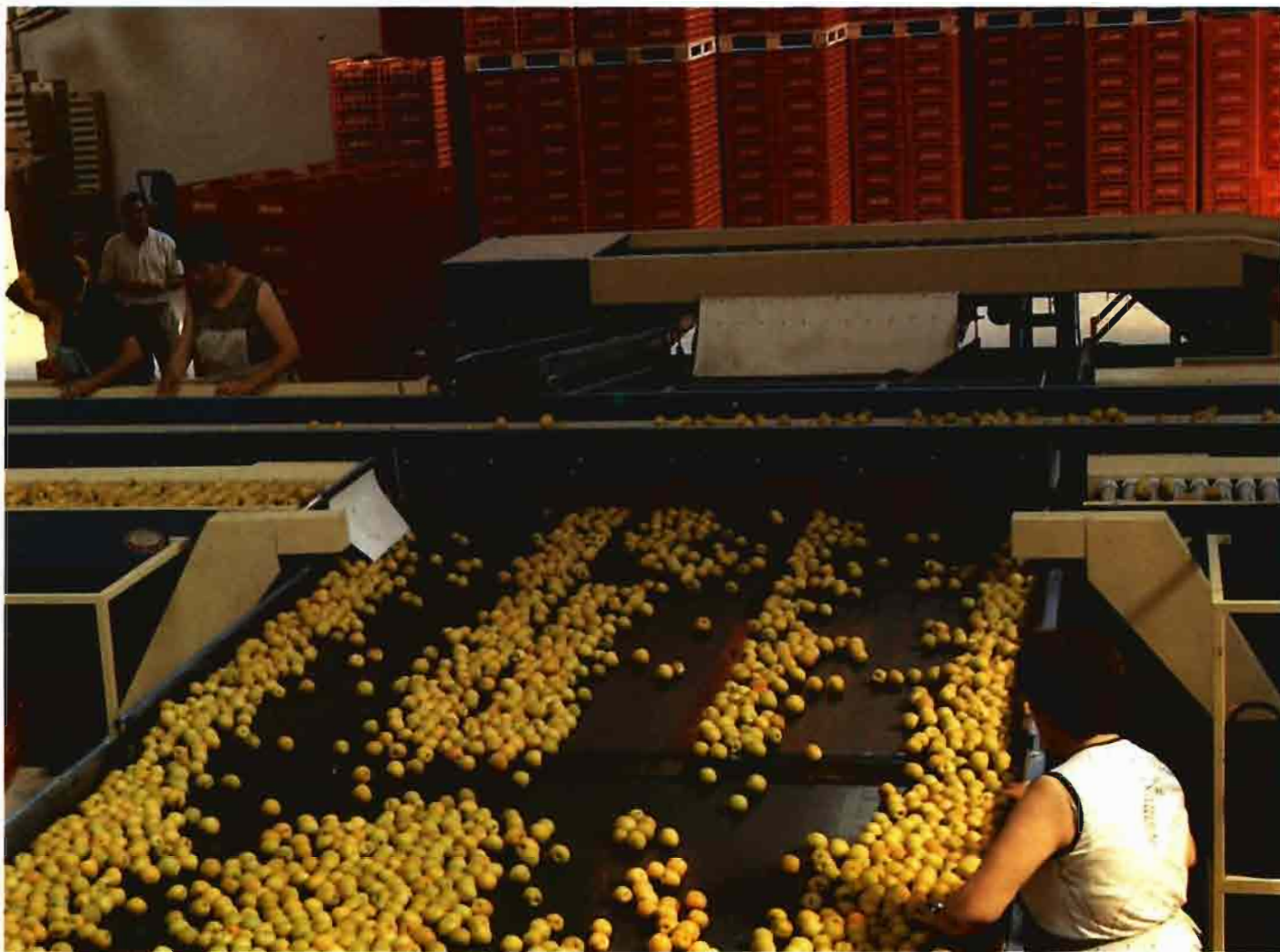
El destrío suele ser una operación que se realiza manualmente, aunque cada vez se utilizan con más frecuencia las calibradoras.
