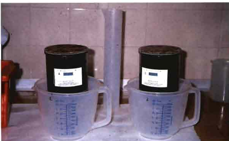
En la fotografía superior, llenado del cilindro de medida. Debajo, saturación del sustrato y por último, drenaje.
