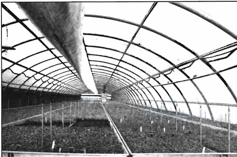
Cubierta rígida de placas de PVC bi-orientado. Este tipo de cubierta aunque poco difundido, ofrece una gran resistencia mecánica.
