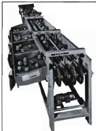
Calibradora a cordones divergentes. La progresiva separación de los cordones en su traslación longitudinal permite la separación de las piezas en función de su diámetro. Mediante la repetición del elemento básico -el par de cordones divergentes- se dimensionan máquinas capaces de procesar mayores volúmenes por unidad de tiempo. Izq., Fomesa; al lado, Caustler.
