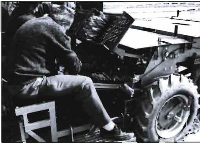
Disposición de hileras de plantel de lechuga con taco cúbico en la plantadora modelo PM. (Foto 8). Al lado, moto sembradora con tracción a 2 ruedas sobre plancha. (Foto 9).
