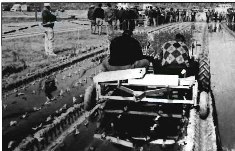
Plantadora cepellón Dewa modelo ST trabajando sobre plancha acolchada. (Foto 5).
