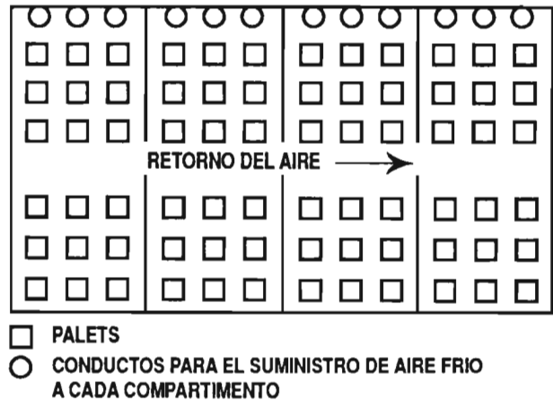
Fig. 10: Cámara provista de compartimentos
