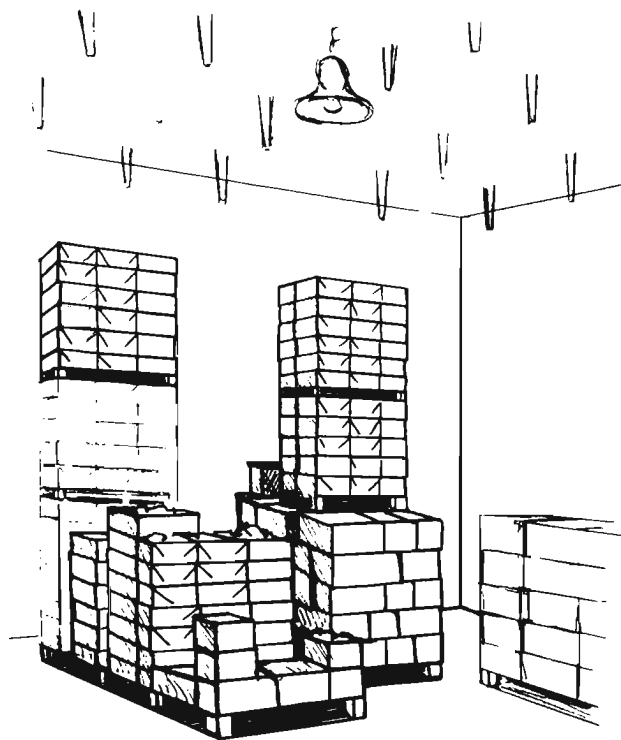
Fig. 9: Enfriamiento por chorros
