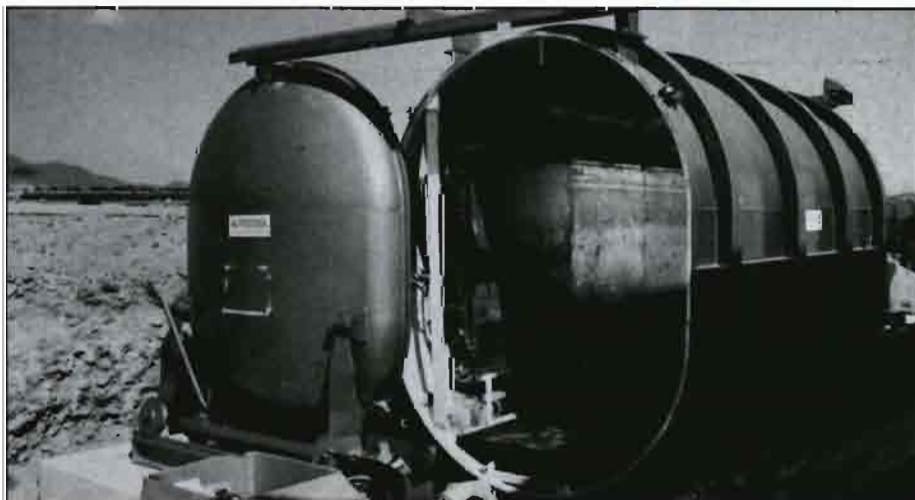
Máquina de vacuum cooling de AutoCool, S.A., preparada para trabajar con producto envasado y paletizado.
