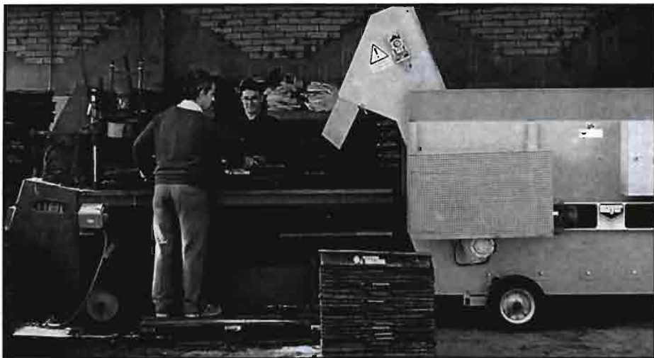
Operación de llenado de macetas y elaboración de sustrato simultáneo para el formato de M-11 cm de diámetro. Abajo grupo de operarias durante la plantación del ING en M-11.
