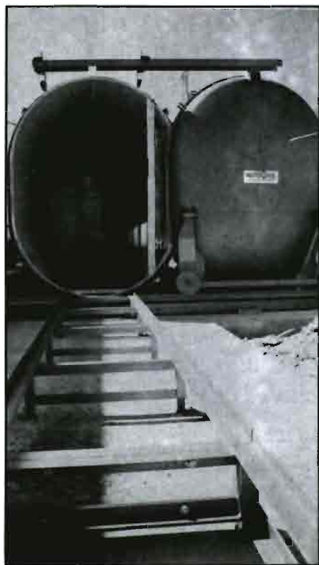
Máquina de vacuum cooling con una capacidad de 4 palets. La carga se realiza automáticamente por trineos. Estas máquinas están diseñadas para que trabajen con producto envasado y palletizado. AUTOOL, S.A., dispone de máquinas de 2 a 10 pallets de capacidad, ideal para preenfriar los productos tales como lechugas, brocolis, espinacas, apios, pueros, etc...
