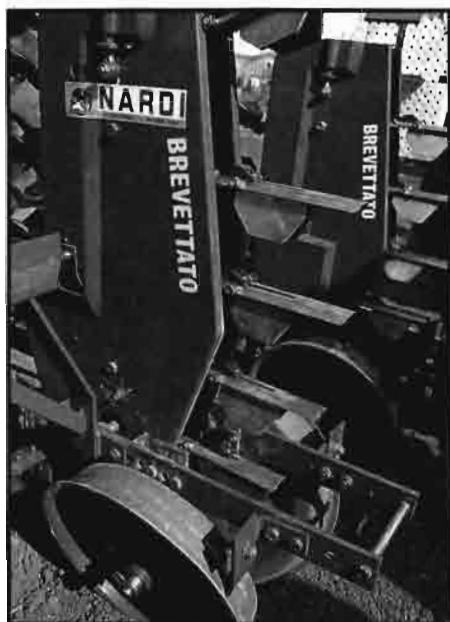
Trasplantadora Nardi, modelo Tuf. Emplea la pinza como elemento de transporte en la máquina.
