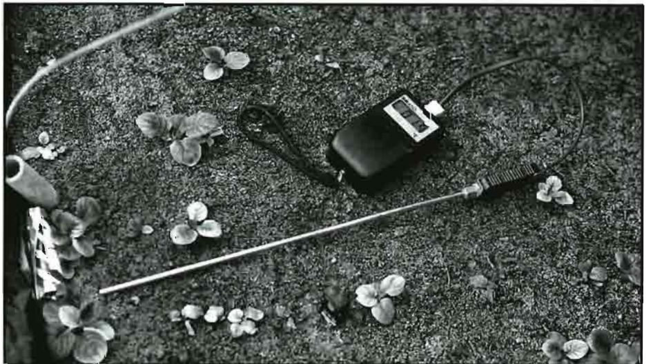
Sonda térmica para control de la temperatura en el sustrato del semillero.
