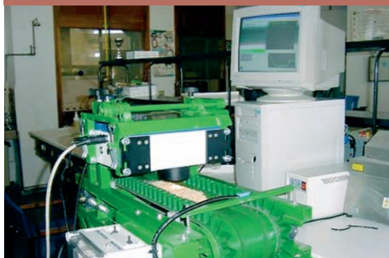
Figura 3 Simulación en laboratorio del análisis NIRS "on-line" de piensos compuestos
