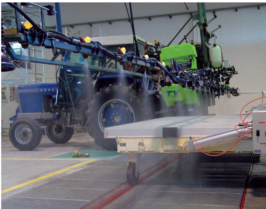
Ensayo de distribución horizontal de una barra en el laboratorio del Centro de Mecanización Agraria. Foto: A. Fillat
