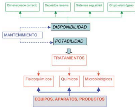
Figura 1. Requisitos de la instalación de agua
