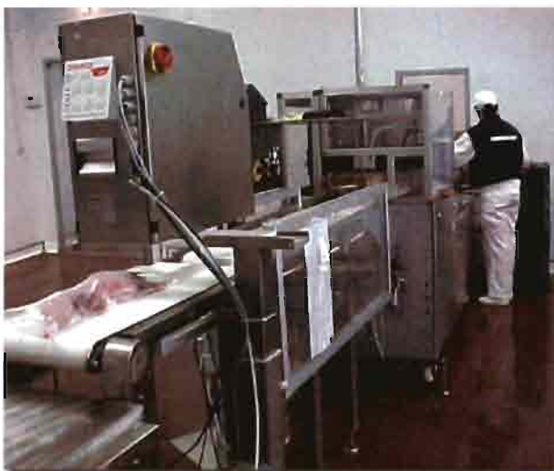
Fig 4.- Utillaje para estuchado individual de las canales enteras. Esta máquina no solo efectúa el embolsado, sino que imprime las etiquetas, indicando: peso, caducidad y referencias de cada canal. Antes del cerrado se introduce el hígado cerrado al vacío.
