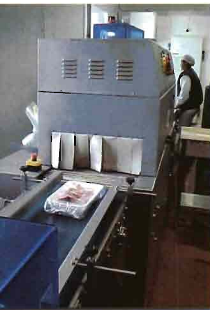
Fig 9.- Las bandejas una vez recubiertas pasan por un tunel en el cual se introduce el gas conservante y se produce el tensado del plástico. Una vez la bandeja queda perfectamente situada, se coloca la etiqueta correspondiente, identificando el producto.
