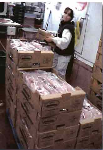
Fig 10.- Las bandejas son introducidas en cajas de cartón, con cuatro bandejas de fondo, sin abandonar la red de frío, pasándose al almacén correspondiente. La estancia de los productos cárnicos es de un día siendo expedida con rapidez. El despiece se realiza todos los días de la semana, excepto el domingo.
