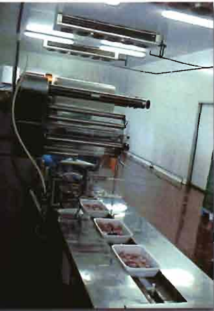
Fig 8.- Colocación de las bandejas con los productos, y recubrimiento de las bandejas con plástico.
