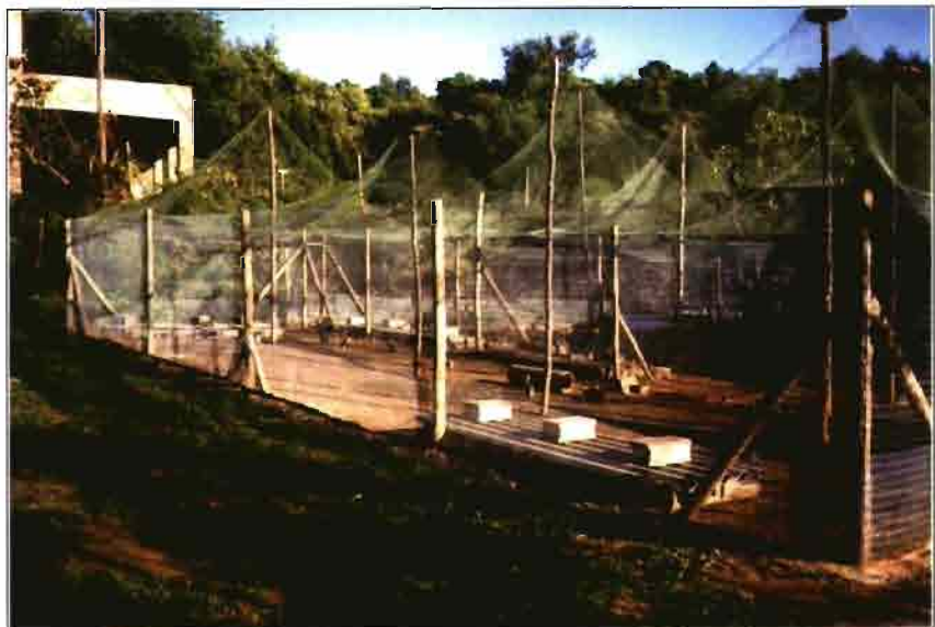
Vista general de una de las áreas de semilibertad. Obsérvese la rusticidad del cercado, bordeado de hormigón para evitar huidas y la cubierta zenital de malla para evitar las aves rapaces.
