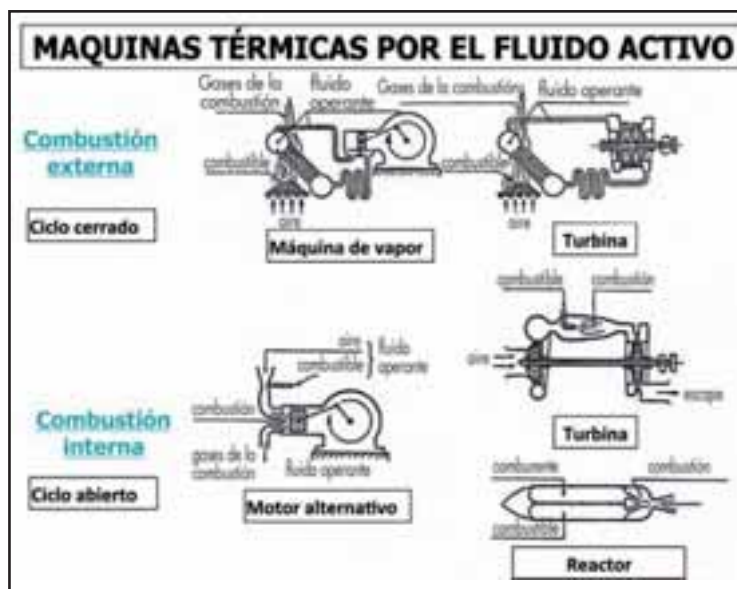
FIGURA 1.- TIPOS DE MÁQUINAS TÉRMICAS
