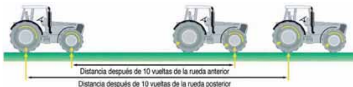
FIGURA 1.- CÁLCULO DE LA RELACIÓN MECÁNICA Y DE LA RELACIÓN DE RADIOS
