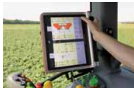
Monitor ISO-BUS se doble pantalla (Kverneland).
