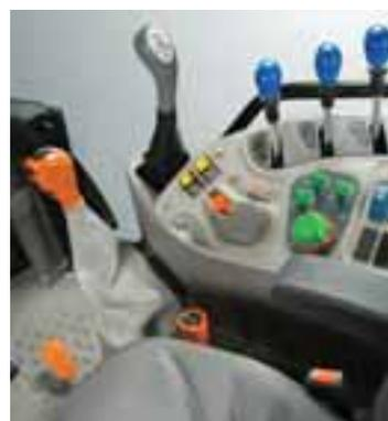
electrónico, que permite controlar los aperos con suma precisión. Además está disponible la TDF automática, que se acopla y desacopla al bajar o elevar el apero. La capacidad de elevación va de los 4 855 kg a los 5 410 kg según el modelo.
