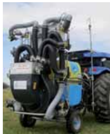
Tractor con máquina pulverizadora para tratamiento de plagas en copas de los árboles.
