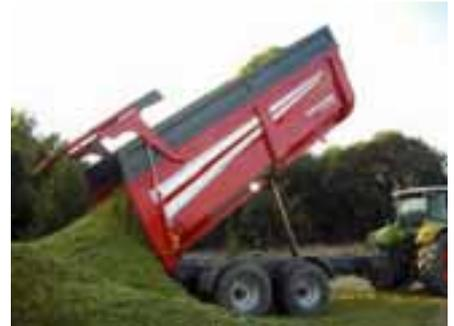
Esta bañera también dispone de un amplio equipamiento opcional como eje direccional, plataforma frontal, ballesta en lanza, sobrelaterales de diversas medidas, amplia gama de neumáticos homologados, entre otros.
