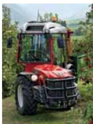
mecánicas (trabajo o desplazamiento): la primera de 0 a 15 km/h; la segunda de 0 a 40 km/h. Cada gama dispone de tres velocidades hidráulicas que pueden cambiar en marcha, sin discontinuidad de marcha alguna, a través de un cómodo interruptor. El
