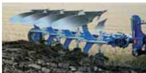
Un nuevo arado reversible completamente suspendido de 5 cuerpos, para tractores de hasta 200 CV. Está disponible en dos versiones, con 90 cm ó 100 cm de distancia entre cuerpos; ambos con un despeje de 75 cm. Este modelo de arado está equipado con un robusto cabezal y con un eje de volteo de 150 mm, así como con rodamientos de aguja. La anchura de labor se ajusta hidráulicamente. La estudiada geometría del sistema de regulación, hace posible ajustar la anchura de labor en marcha.
