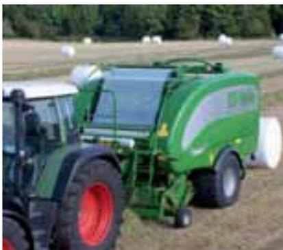
Permite el atado con plástico sobre la parte curva de la paca en la cámara de empacado sustituyendo a la red. Esto aporta mayor cantidad de plástico en la superficie de la paca en la zona curvada. Al aplicar el plástico en la paca, éste se estira aproximadamente un 20%; estiramiento mayor que el que se consigue con malla o cuerda durante el atado convencional, consiguiendo un mayor apriete y la mejor forma de las pacas. Es una
