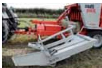
permitir auto-alinear o reorientar las balas mediante guías sin que ello se traduzca en roturas de hilo, que las balas realicen trayectos curvos con radio de giro muy pequeño y sacar las balas de la línea de desplazamiento en sentido transversal a la dirección de transporte.
