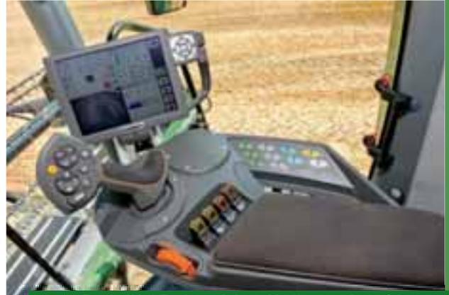
Terminal VarioTronic con Palanca Multifuncional PowerGrip.
