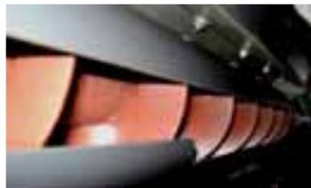
Sistema de Retornos al cilindro de corte biselado para una distribución uniforme del material con Sensor de Retornos.
