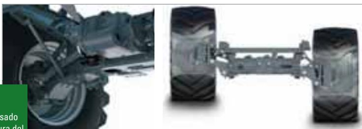
Sistema de nivelación ParaLevel basado en la estructura del paralelogramo.
