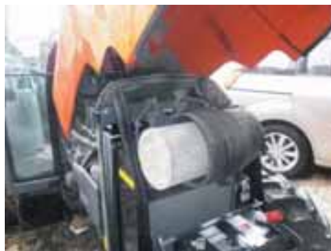
Capó levantado para acceder a la batería, filtro del aire y radiadores.
