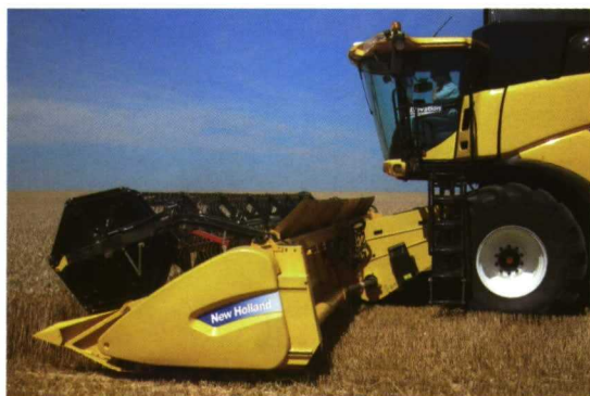
El ajuste perfecto del cabezal a las características de la parcela y condiciones del cultivo se consigue gracias al nuevo sistema IntelliCruise™ , que permite ajustar de forma automática la velocidad de la cosechadora en función de la carga.
