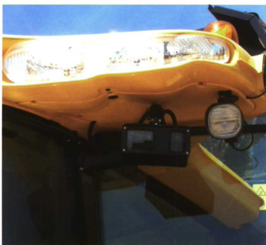
Sensor del sistema SmartSteer™ de guiado automático de la cosechadora.
