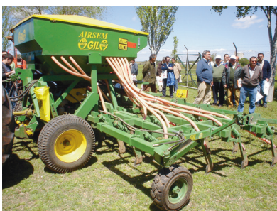
La empresa Gil presentó una máquina de siembra directa arrastrada de rejas con distribución neumática, que incorpora una rastra de púas en la parte posterior, lo que facilita el enterrado de la semilla. La tolva instalada es de 2 000 L de capacidad; tiene distribuidor volumétrico que permite sembrar semillas de distinto tamaño. La distribución se realiza en cuatro filas con una separación de 16 cm entre líneas.
