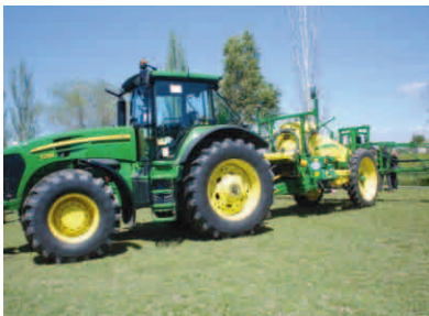
John Deere presentó un pulverizador arrastrado de la serie 700 (concretamente el pulverizador 724), con una capacidad de 2 400 L (aunque la serie incluye capacidades de 3 200 y 4 000 L). La barra, con sistema de suspensión, tiene posibilidad de doble o triple plegado, lo que facilita el transporte.
