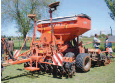
Kuhn presentó la sembradora neumática SD 3000, con 2 000 L de capacidad de la tolva; se trata de una sembradora de discos, con distribución neumática y rueda para el control de la profundidad.
