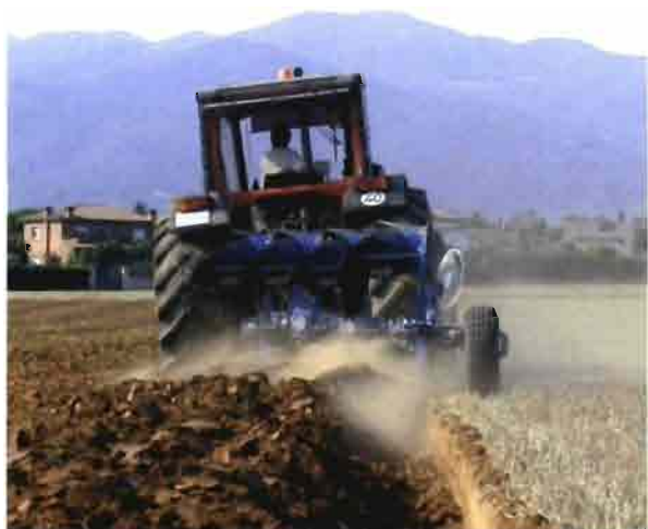
Detalle de la pared del surco efectuada con la cuchilla
