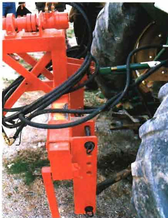
Figura 3. Enganche diseñado para el acoplamiento al tractor.
